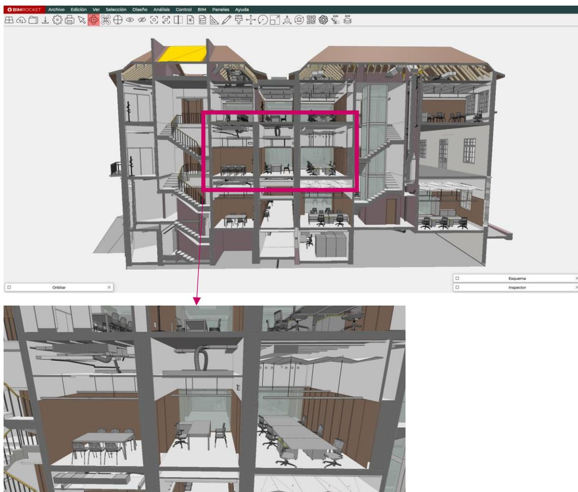
*Figura 2: Visualización en sección del gemelo digital de la sede del ayuntamiento de Sant Feliu de Llobregat, con una imagen complementaria de zoom en la cual se aprecia: Arquitectura, estructuras, instalaciones y mobiliario.*
