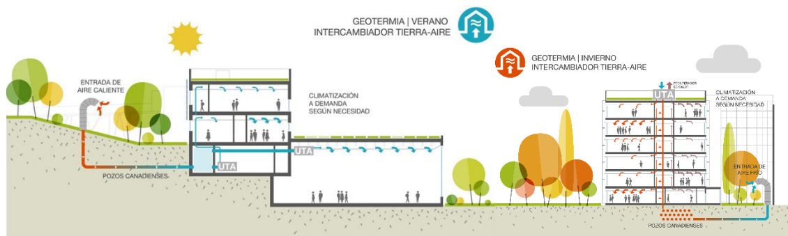
Figura 3: Climatización mediante pozos canadienses en el Campus de Soria y el edificio IndUVa.
