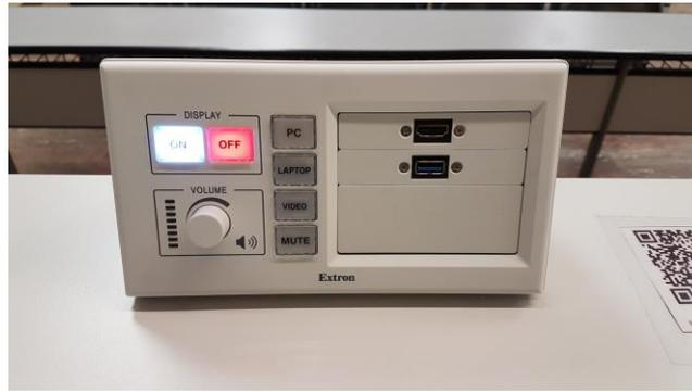
Imagen 4. Panel de control y de conexiones
